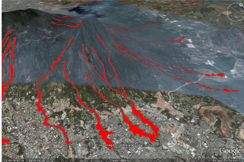
Figura 6: Superposición de las superficies del lahar para los 100.000 m 3 en la imagen tridimensional del Google Earth. (J.J. Major et al. 2001, USGS).
