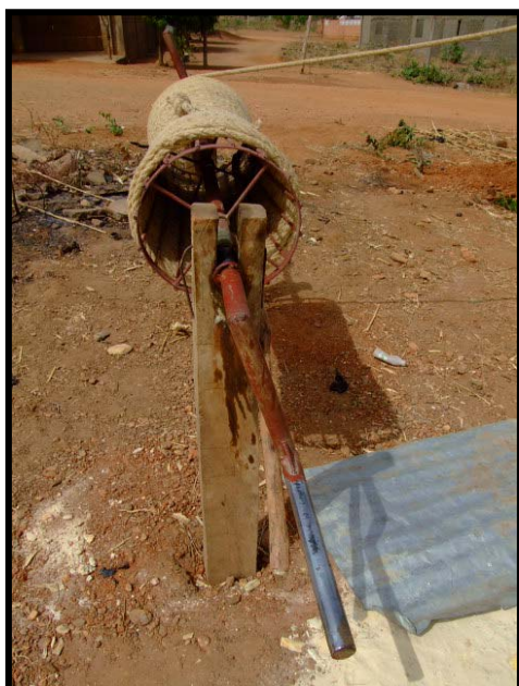
Foto. Solución al elevar la cuerda con una manivela alta + sistema de polea para subir el cubo (Benin)
